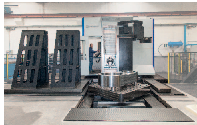
La Soraluce FL 6.000 installata presso Officina Meccanica Tentori è configurata con banco fisso e tavola rototraslante
